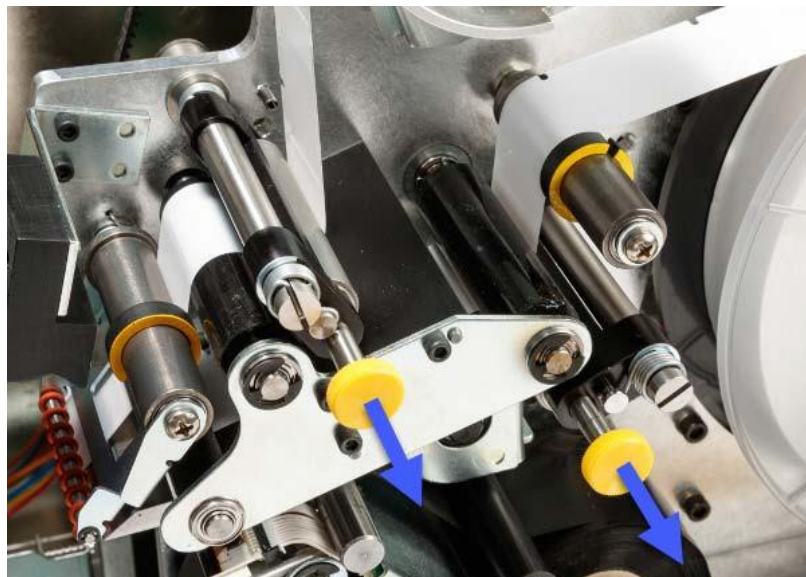
図4-9 ニップローラーを動かす
