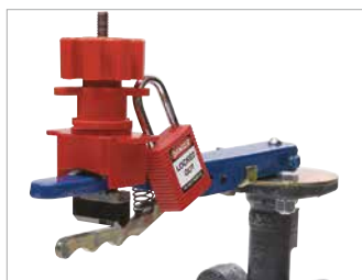
バタフライバルブのハンドルをクランプでおさえて逆戻りを防止。
