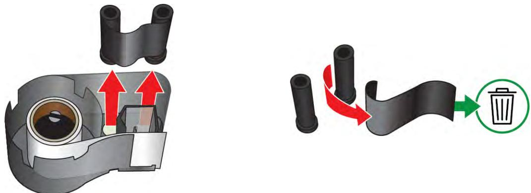
5. ラベルを持ち上げてカートリッジハウジングから取り出し、ラベルコア内部から黒いプラスチックシリンダーを取り出します。
