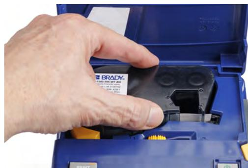
5. カートリッジのラベルを上向きにした状態で、カートリッジ取り付け部にカートリッジを置き、カチッという音がするまでゆっくり押し込みます。1/2 インチまたは3/4 インチのカートリッジを使用する場合は、カートリッジを正しい位置に押し下げる際にヒンジ付きタブを持ってください。
