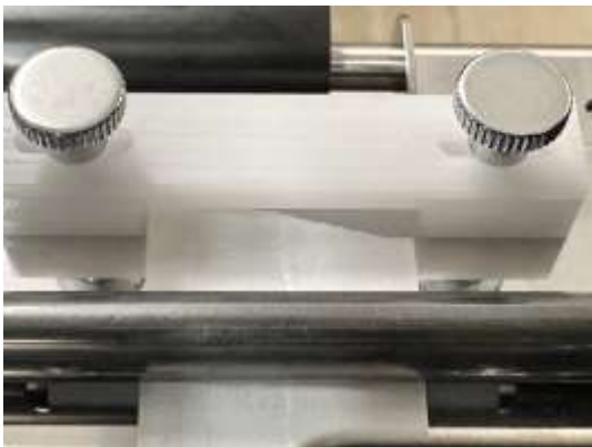
(剥離ガイド-後ろから)
