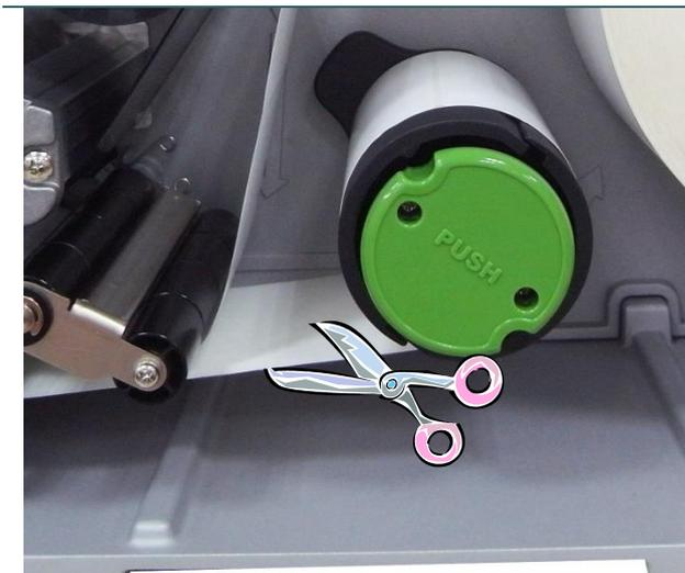
1.ピールオフローラーと内部巻き取りスピンドルの間でライナーを切断します。
