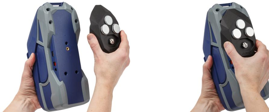
2. ネジのハンドル部を上げて、ネジを手で締め付けます。
