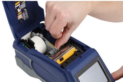
6. プリントヘッドが固定されていることを確認します。ロックレバーがプリンタの前方を向いていることを確認します。
