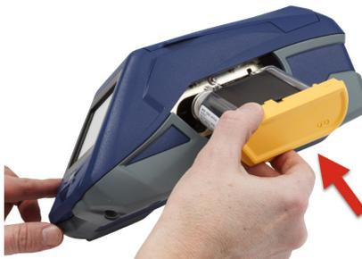
4. ロック レバーをプリンタの前面に向けて回し、ロックします。
