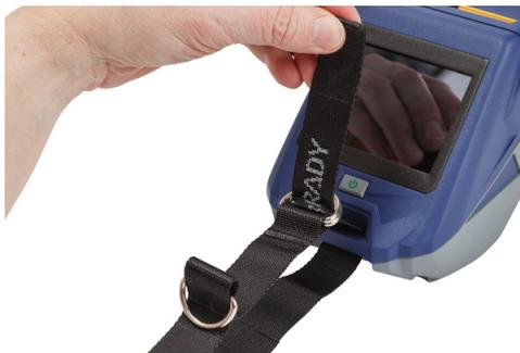
3. 2つのDリングを離し（これらのリングの間をストラップが通れるよう十分な隙間を維持します）、ストラップの端を2つのリングの間に再び通します。
