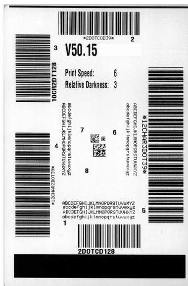
4. [バーコードの品質判定\(219 ページの\)](#) を参照してください。テスト・ラベルを検査して、どのラベルがアプリケーションに最適な印刷品質であるか判断します。バーコード検証器がある場合は、バーコード検証器を使用してバー / 空白部分を測定し、印刷のコントラストを計算します。バーコード検証器がない場合は、目視およびシステム・スキャナを使用して、このセルフ・テストで印刷されるラベルに基づいて最適な濃度設定を選択することをお勧めします。
