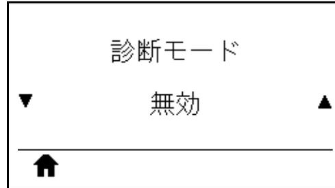
プリンタが受信するすべてのデータの 16 進値をプリンタで出力するには、この診断ツールを使用します。詳細については、[通信診断テスト \(228 ページの\)](#) を参照してください。
