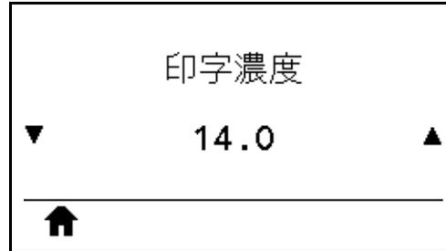
印字濃度は、良好な印字品質が得られる最低値に設定してください。印字濃度の設定が高すぎると、ラベルの印字イメージが不鮮明になったり、バーコードが正しく読み取れなくなったり、リボンが焼け付いてしまったり、印字ヘッドの磨耗を早めてしまう場合があります。
