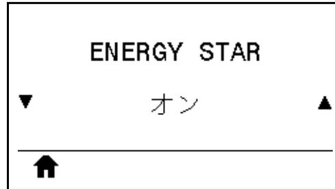
ENERGY STAR モードが有効な場合、タイムアウトの時間を過ぎるとプリンタは「スリープ」モードに入り、電力消費を減らします。コントロール・パネル上で任意のボタンを押すと、プリンタはアクティブな状態に戻ります。
