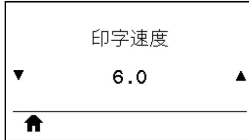
ラベル印刷の速度を、1秒あたりのインチ数 (ips) で選択します。通常、印字速度を遅くすると、印字品質は向上します。
